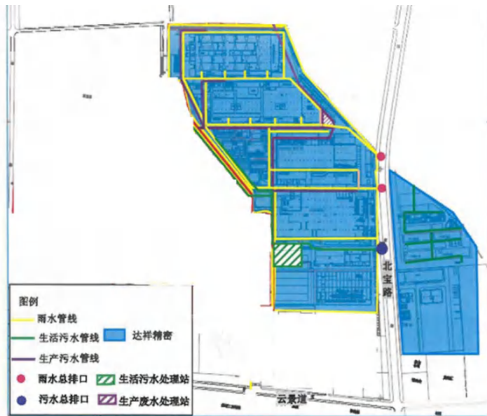
图 8.7-4 厂区雨污管网及排放口分布图
