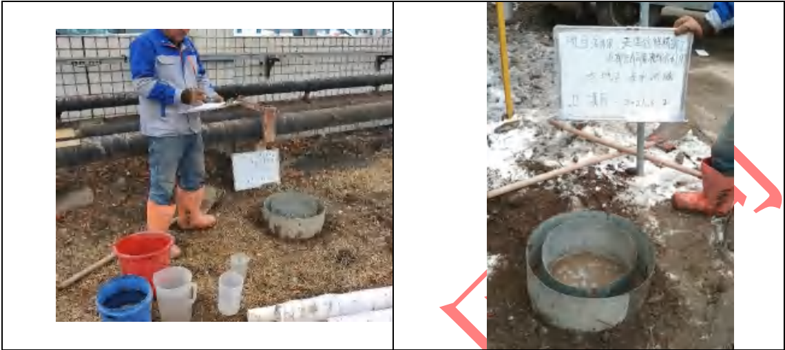
图 6.6-6 现场渗水试验
