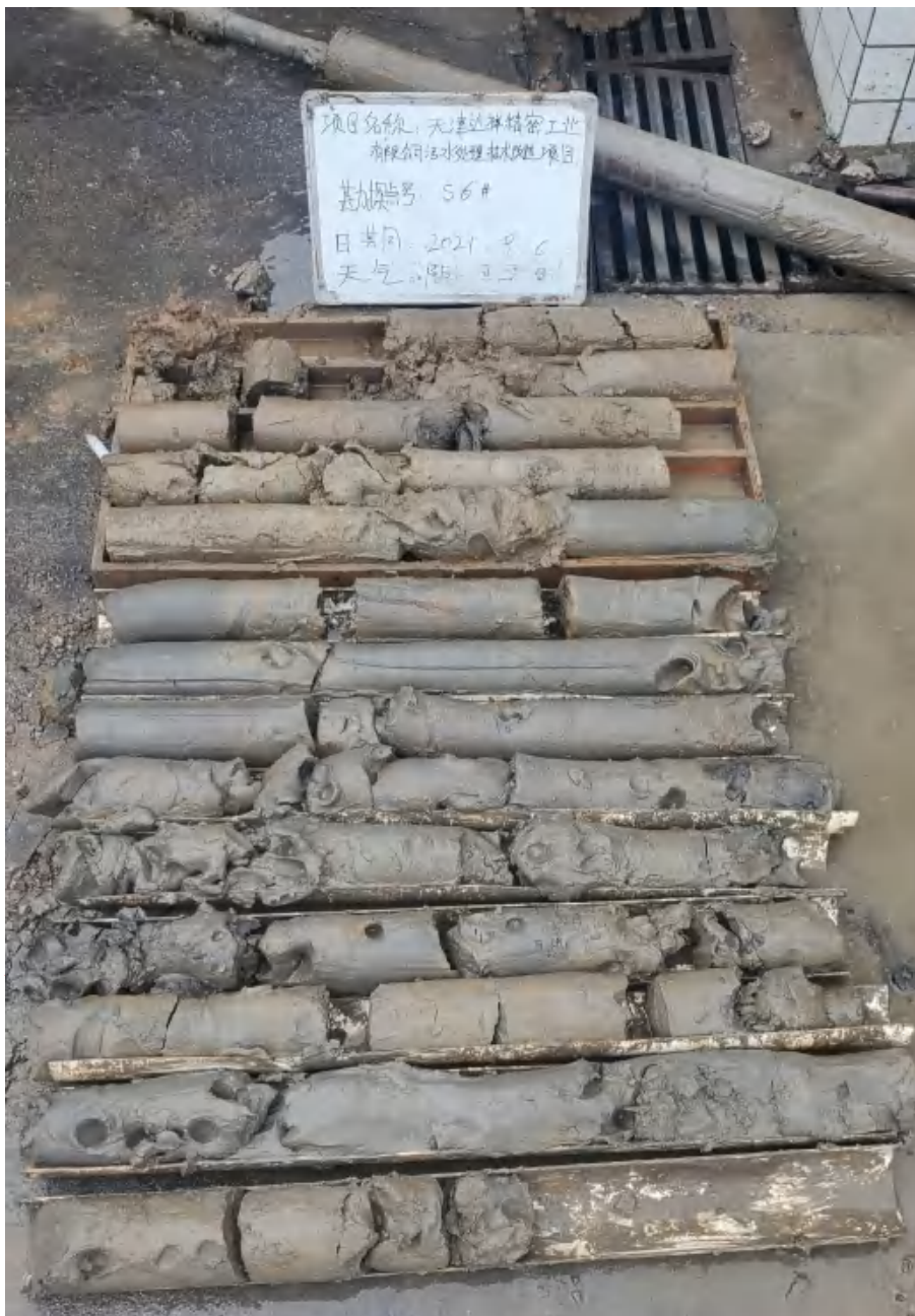
图 6.5-1 现场岩芯照片
