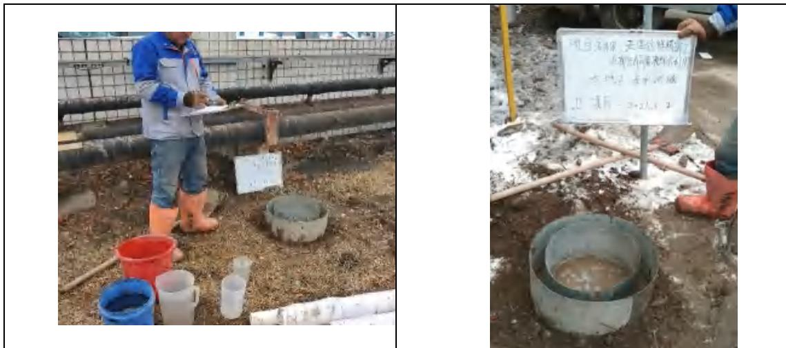
图 6.6-6 现场渗水试验
