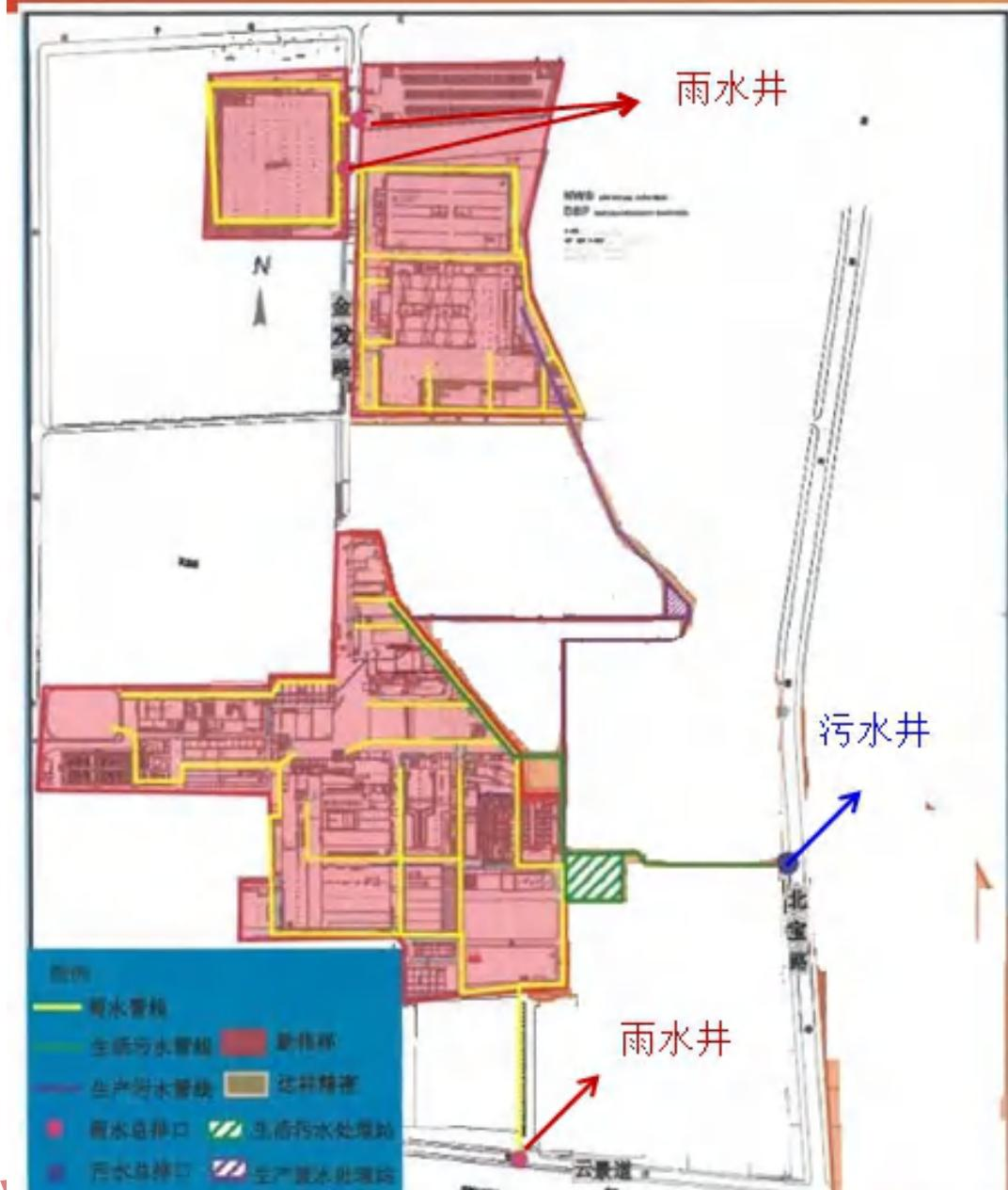
图 8.7-4 厂区雨污管网及排放口分布图
