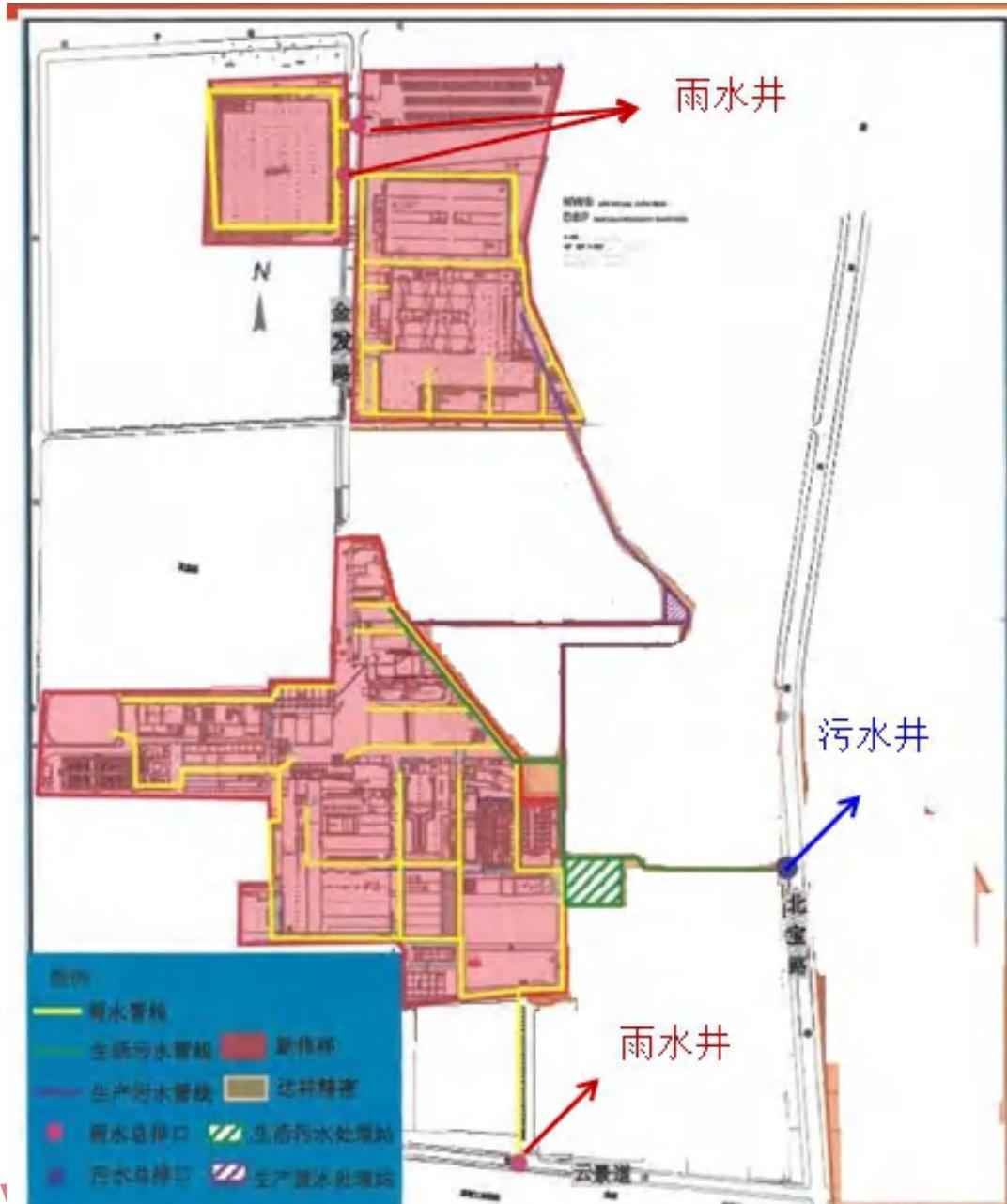
图 8.7-5 厂区雨污水总排口、应急水池、消防水箱、雨水蓄水池分布图
