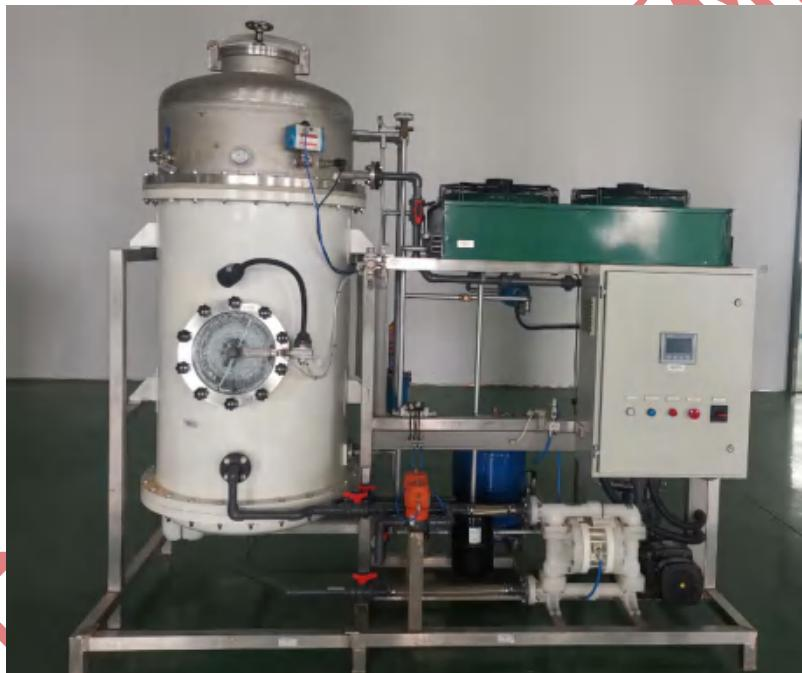
图 5.4-5 低温蒸馏设备样机图
