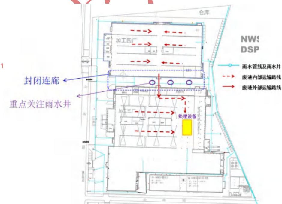
图 8.7-7 机加工废液处理系统废液运输路线图
