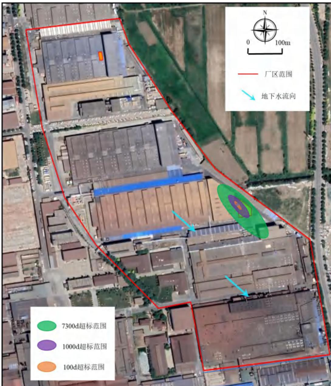
图 8.5-4 地下水中石油类渗漏时扩散超标范围
