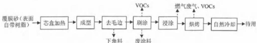
图 3.7-3 热芯工序流程图
